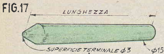
Fig. 17 - Tipo consigliato per punta saldante diritta. Quella inferiore, S deve essere lunga, mm. 100, quella superiore, invece deve essere lunga mm. 150
